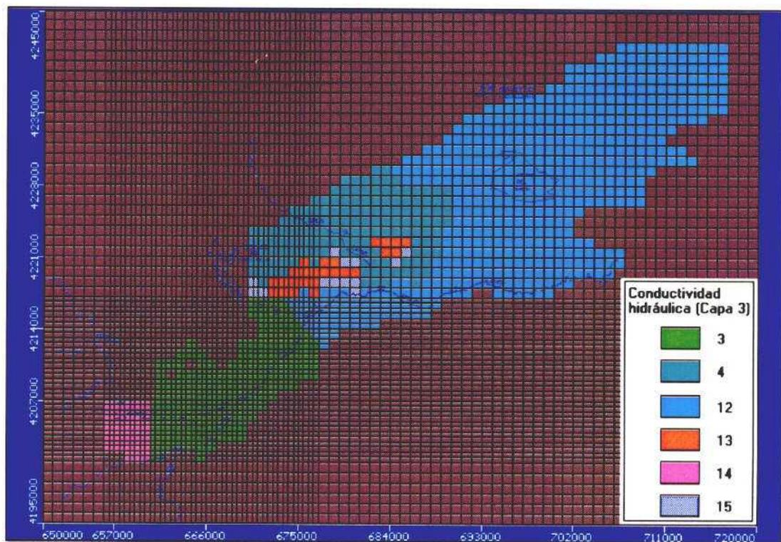
Figura 3.9. – Zonificación final de la conductividad hidráulica en el modelo numérico (Capa 3)
