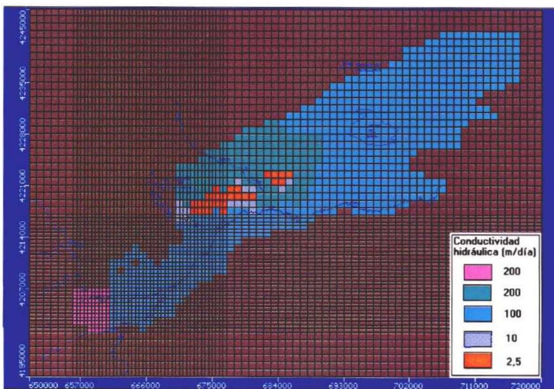
Figura 3.7. – Zonificación inicial de la conductividad hidráulica en el modelo numérico (Capa 3)
